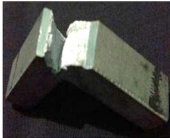
Gambar 3. Penampang Patah Aluminium 5083 Setelah di Uji Impact (Pengelasan dengan Variasi Arus 160 A)
