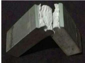
Gambar 2. Penampang Patah Aluminium 5083 Setelah di Uji Impact (Pengelasan dengan Variasi Arus 140 A)
