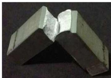
Gambar 4. Penampang Patah Aluminium 5083 Setelah di Uji Impact (Pengelasan dengan Variasi Arus 180 A)
